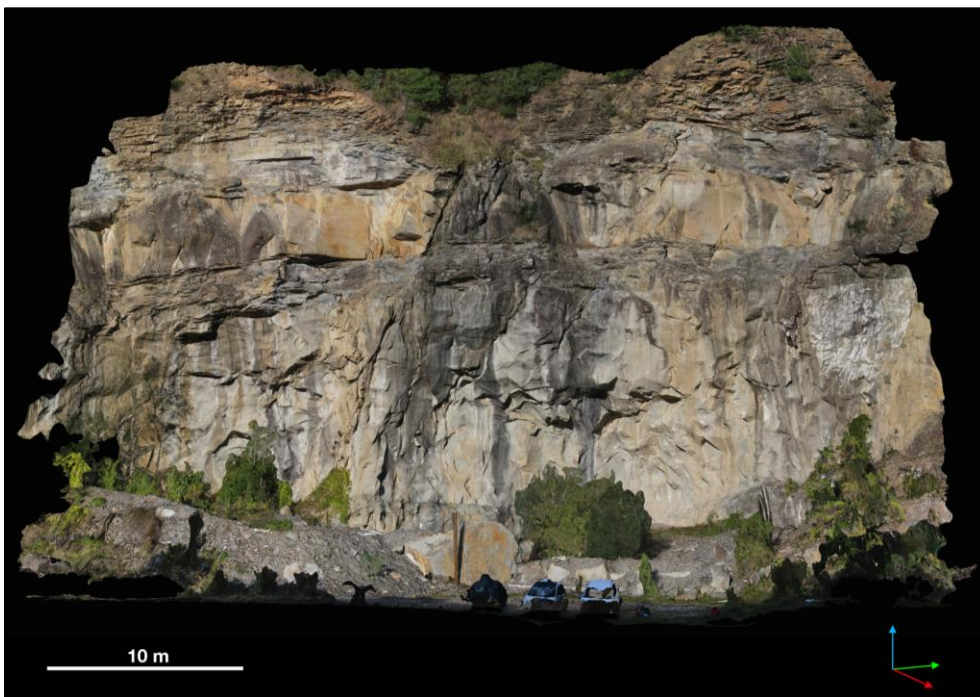
Figura 3 – Esempio di nuvola di punti ad alta risoluzione in colori reali acquisita mediante sensore LiDAR terrestre e fotogrammetria da drone (da Gigli et al. , 2022).
