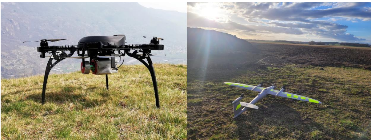
Figura 4 – A sinistra, drone M2 (coperto da brevetto) equipaggiato con sensore LiDAR a lungo raggio e capacità di carico utile fino a 10 kg; a destra, drone ad ala fissa (modello Trinity Pro) a decollo verticale.
