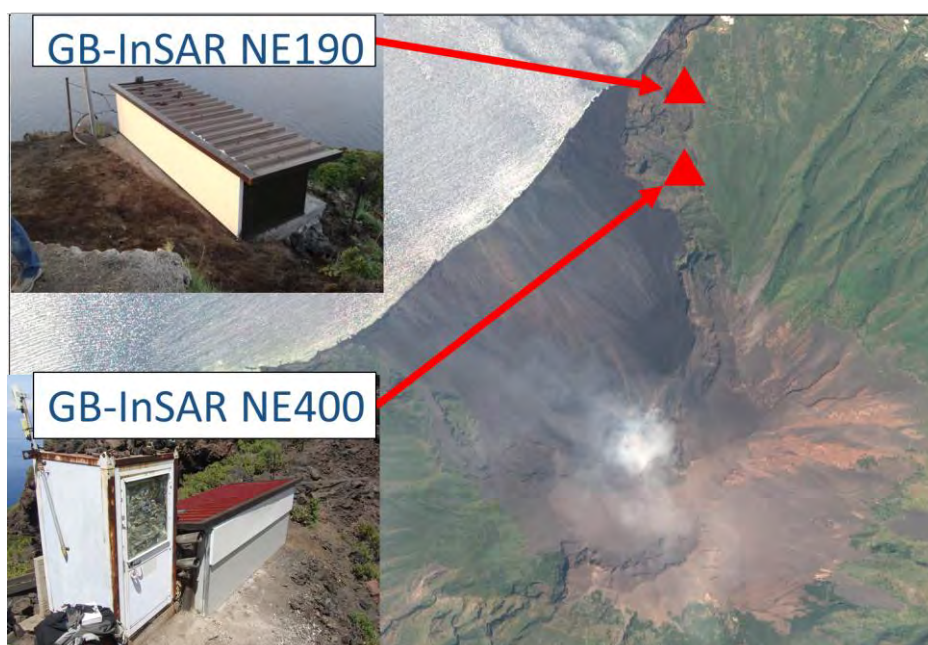
Figura 9 - Vista dei due sistemi GB-InSAR e loro localizzazione.
