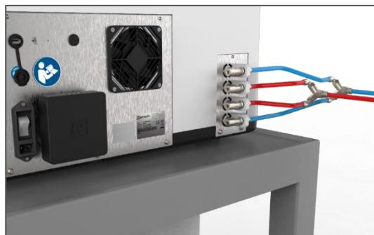
In questa configurazione è di fatto possibile operare in un range di temperatura compresa tra i -100 ed i +100 °C.
